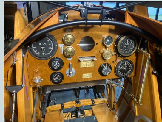
Der komplett fertige Rumpf, einschließlich Steuerkabel, Tanks, Sitz und Rumpfbekleidung, wurde in das Luftfahrtmuseum in Mladá Boleslav transportiert, wo der Motor zusammengebaut, das Treibstoff- und Ölmanagement, Instrumente einschließlich einer Funkstation usw. eingebaut wurden.
